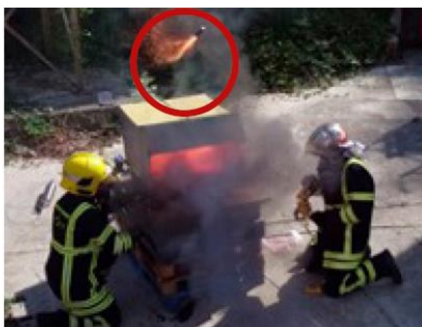
Kuva 13 Akkujen osia voi lentää useiden metrien päähän
